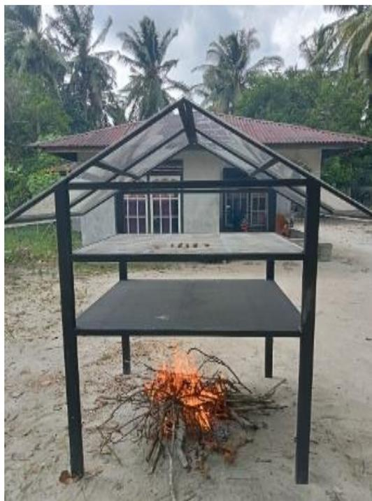
Gambar 4. Pengeringan teripang menggunakan alat pengering hybrid.
