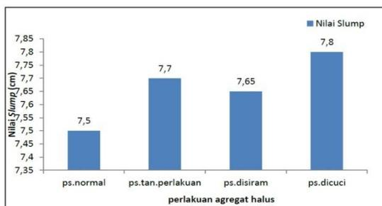
Gambar 2. Nilai *slump* dengan perlakuan agregat halus yang berbeda
