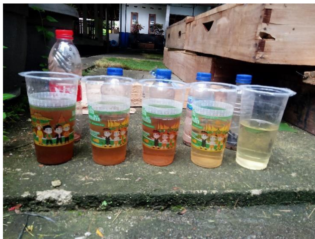
Gambar 7. Hasil pengolahan air limbah dengan berbagai formula selama 3 jam pengendapan. (1) tawas dan limbah (2) Tawas, limbah, dan arang (3) Tawas, limbah, kapur, arang (4) Tawas, limbah, kapur, arang, magnoflok 2 (5) Tawas, limbah, kapur, arang, magnoflok 1.
