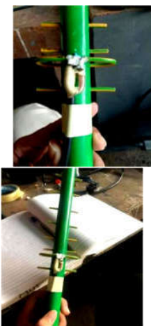
Gambar 10. Pemasangan balun pada boom
