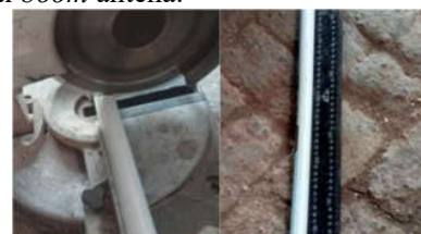
Gambar 6. Pemotongan Boom Antena
