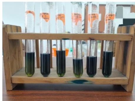
Gambar 2. Hasil uji fiksasi nitrogen media NfB semi solid (48 jam inkubasi) pada tabung yang berbeda ukuran.
