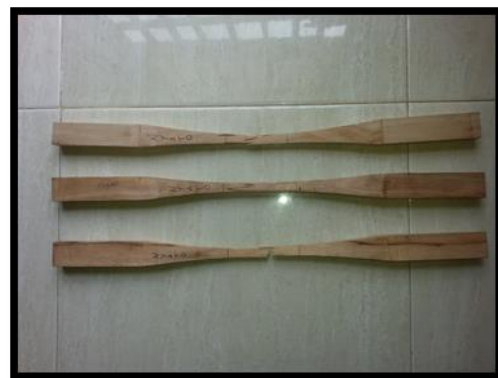
Gambar 8. Material Kayu Nyato, setelah selesai pengujian
