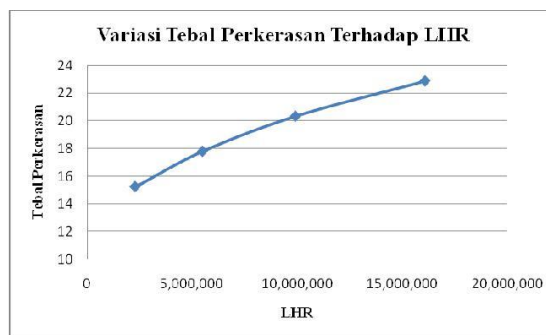
Gambar 6. Grafik Variasi Tebal Perkerasan Terhadap LHR metode Pd T-01-2002-B
