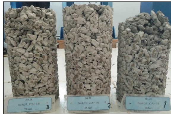
Gambar 15. Kerusakan benda uji kuat tekan (perbandingan semen : agregat 1 : 6 dan faktor air semen 0,35)
