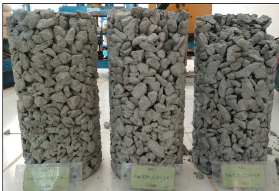
Gambar 7. Kerusakan benda uji kuat tekan (perbandingan semen : agregat 1 : 6 dan faktor air semen 0,3)
