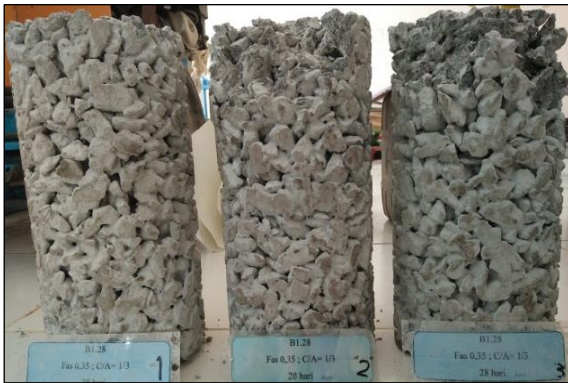
Gambar 12. Kerusakan benda uji kuat tekan (perbandingan semen : agregat 1 : 3 dan faktor air semen 0,35)
