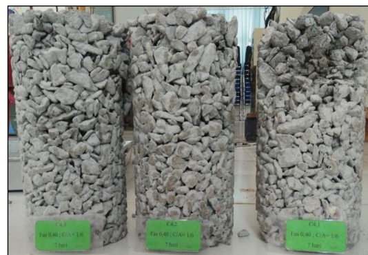
Gambar 9. Kerusakan benda uji kuat tekan (perbandingan semen : agregat 1 : 6 dan faktor air semen 0,4)
