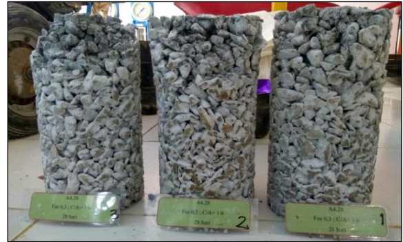
Gambar 14. Kerusakan benda uji kuat tekan (perbandingan semen : agregat 1 : 6 dan faktor air semen 0,3)
