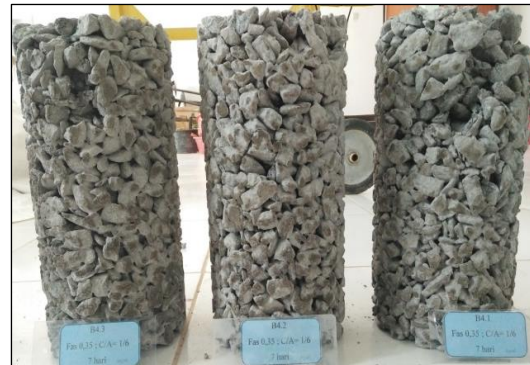
Gambar 8. Kerusakan benda uji kuat tekan (perbandingan semen : agregat 1 : 6 dan faktor air semen 0,35)
