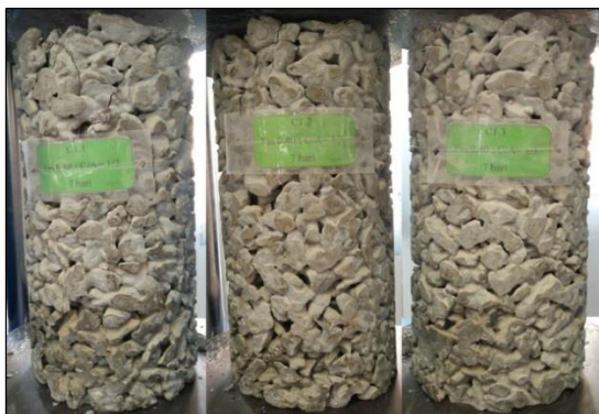
Gambar 6. Kerusakan benda uji kuat tekan (perbandingan semen : agregat 1 : 3 dan faktor air semen 0,4)
