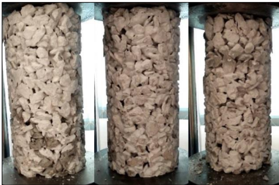
Gambar 13. Kerusakan benda uji kuat tekan (perbandingan semen : agregat 1 : 3 dan faktor air semen 0,4)
