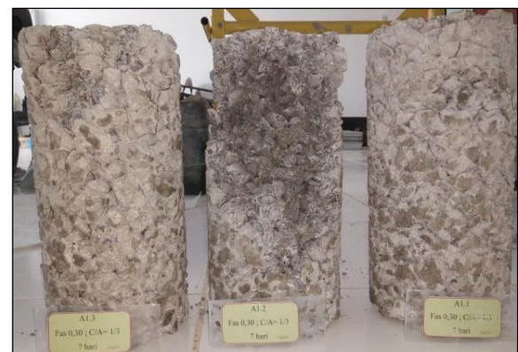
Gambar 4. Kerusakan benda uji kuat tekan (perbandingan semen : agregat 1 : 3 dan faktor air semen 0,3)
