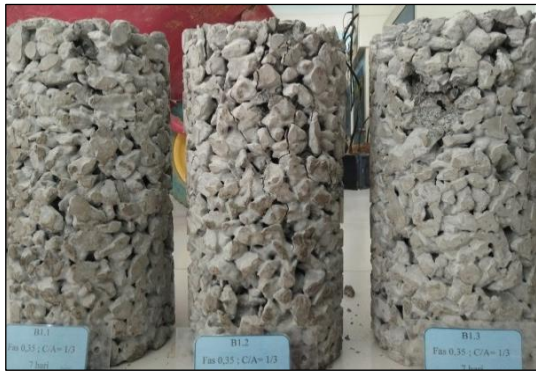
Gambar 5. Kerusakan benda uji kuat tekan (perbandingan semen : agregat 1 : 3 dan faktor air semen 0,35)
