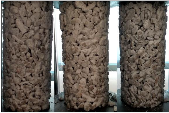
Gambar 11. Kerusakan benda uji kuat tekan (perbandingan semen : agregat 1 : 3 dan faktor air semen 0,3)
