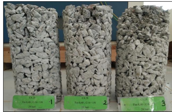
Gambar 16. Kerusakan benda uji kuat tekan (perbandingan semen : agregat 1 : 6 dan faktor air semen 0,4)
