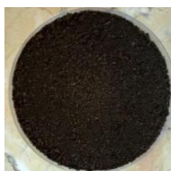
Gambar 2 Hasil aktivasi karbon menggunakan NaOH
