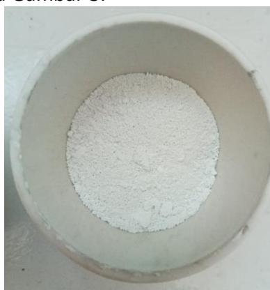
Gambar 3. Serbuk bahan aktif anoda LTO yang didoping \text{CaCO}_3
