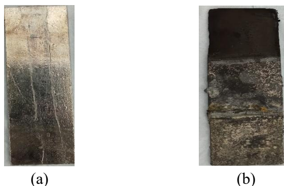
Gambar 3. Plat Timah (a) Plat timah sebelum elektrokimia (b) Plat timah setelah elektrokimia
