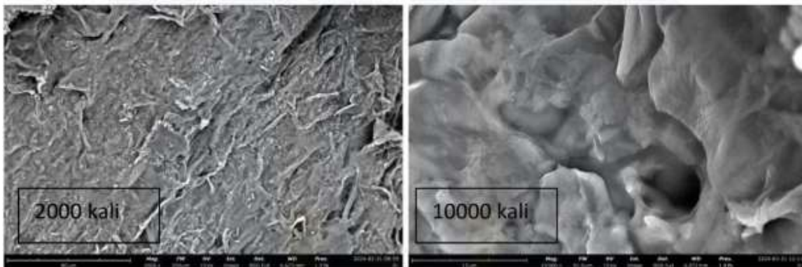
Gambar 6. Morfologi hidrogel dengan perbesaran 2000 kali (kiri) dan 10.000 kali (kanan)
