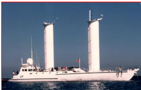
Gambar 1 Dua buah silinder turbosail pada kapal
