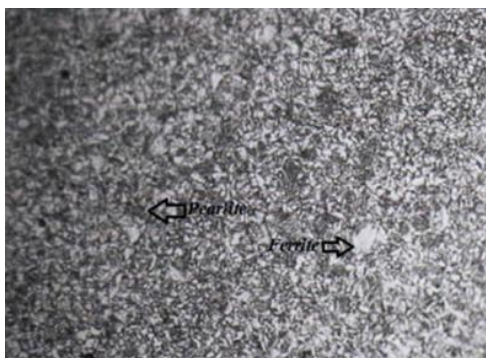
Gambar 18 Struktur mikro pada bagian weld metal SMAW
