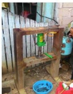
Gambar 3 Alat *press* pneumatik
