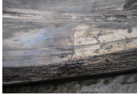
Gambar 10 Retakan pada Inner race bantalan
