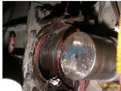
Gambar 10 Retakan pada Inner race bantalan
