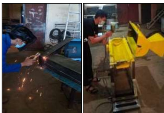
Gambar 3 Proses pembuatan dan perakitan Mesin Pengupas Kulit Polong Kacang Hijau
