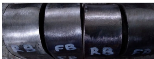
Gambar 19. Hasil Uji Bending Percobaan B Tampak Atas
