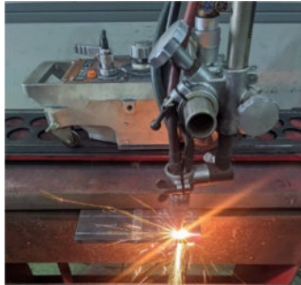
Gambar 13. Pemotongan Spesimen dengan Flame Cutting
