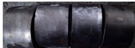
Gambar 17. Hasil Uji Bending Percobaan A Tampak Atas
