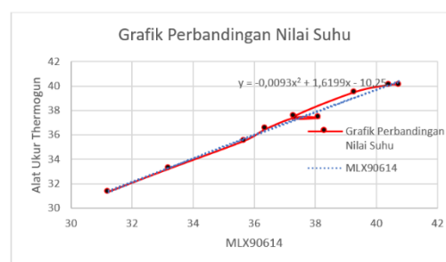
Gambar 8. Grafik perbandingan alat ukur dengan sensor infrared MLX90614
