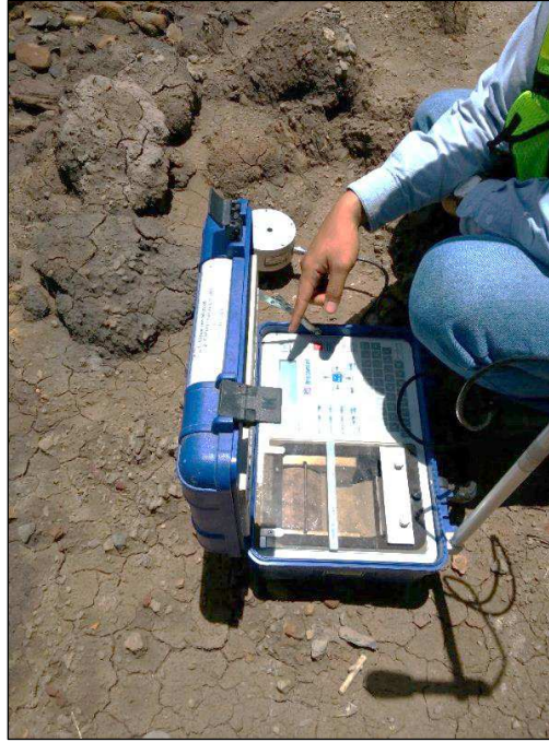
Gambar 3. Kegiatan perekaman getaran menggunakan Blastmate III di Blok MTBU
