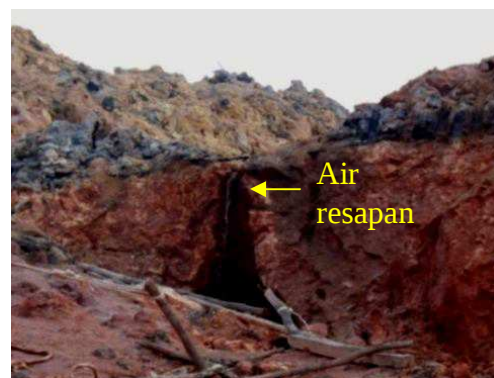
Gambar 3. Air resapan pada Front 2
