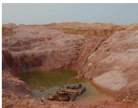
Gambar 4. Kondisi sump saat tidak dilakukan pemompaan selama 6 hari.
