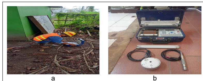
Gambar 2. Pengambilan data : (a) Pengukuran getaran, dan (b) Blasmate III Alat ukur getaran
