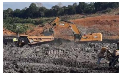
Gambar 5. Pola pemuatan top loading
