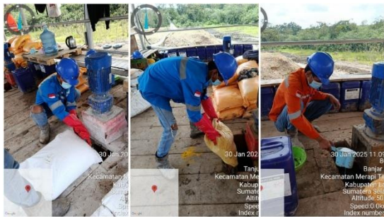
Gambar 7. Penuangan Bahan Kimia Kedalam Mesin Pengaduk
