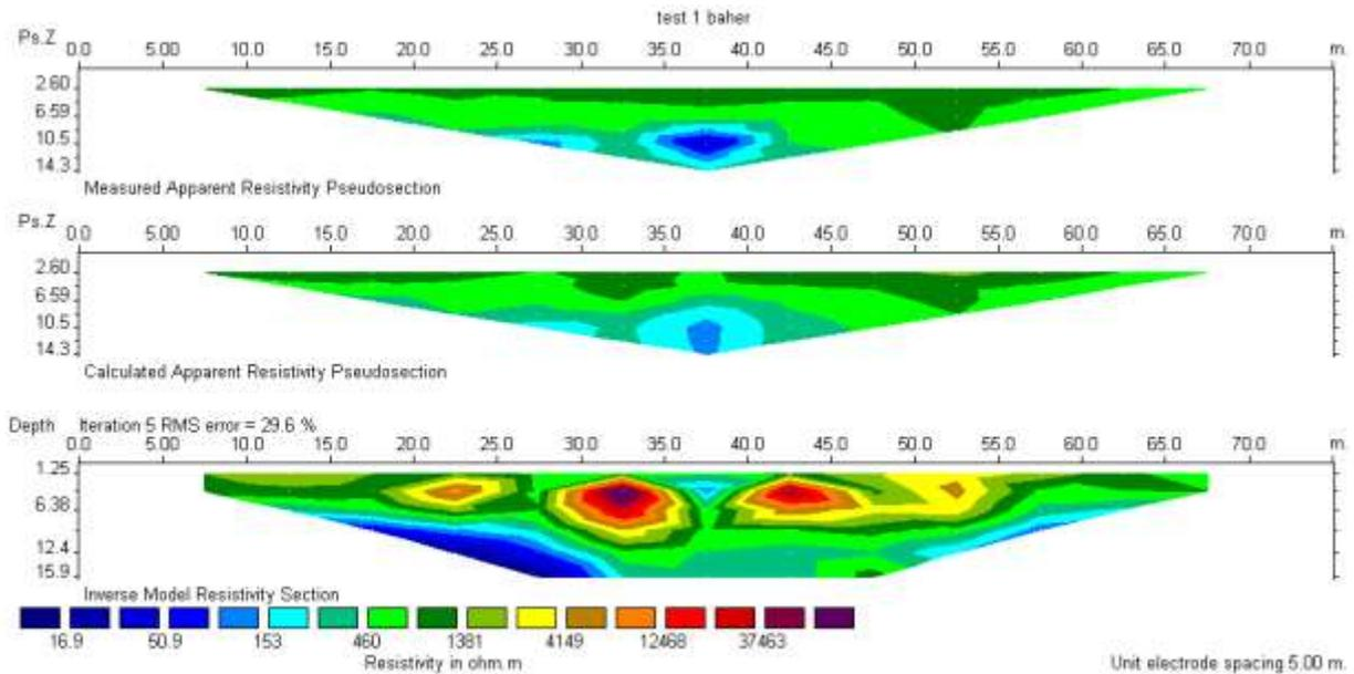
Gambar 7. Hasil Geolistrik Lintasan 2 Metode Schlumberger
