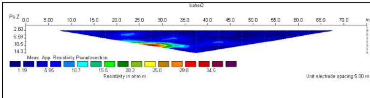
Gambar 5. Hasil Geolistrik Lintasan 1 Metode Schlumberger
