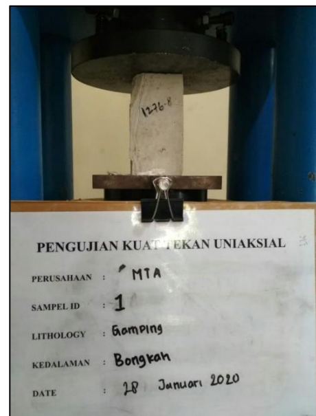
Gambar 2. Proses pengujian UCS
