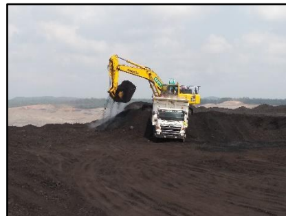
Gambar 2. Pembongkaran timbunan batubara pada pola chevcon .
