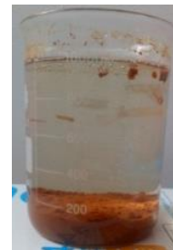
Gambar 2. Pengolahan air limbah kelapa sawit dengan metode Fenton sebelum proses filtrasi terdapat endapan
