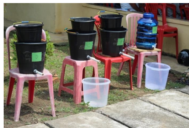
Gambar 3. Saringan Air yang dihasilkan (tipe A, B, C dan D dimulainya dari kanan)
