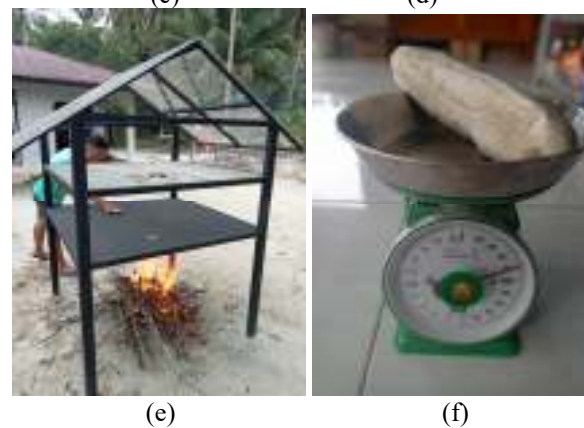
Gambar 5. Bahan baku teripang segar (a); Pencucian dengan daun pepaya setelah perebusan; (c) Teripang setelah pencucian; Pengeringan dengan panas matahari (d); Pengeringan teripang secara hybrid dengan panas api dan matahari (e); dan Teripang segar ditimbang sebelum dikeringkan (f) (Sumber: Dokumentasi pribadi, 2023).
