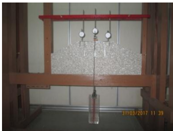
Gambar 9. Alat dan kotak pembebanan yang terpasang pada model tanah timbunan.
