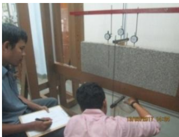
Gambar 10. Proses penambahan beban setiap 100 gram sampai dengan 2 kg.
