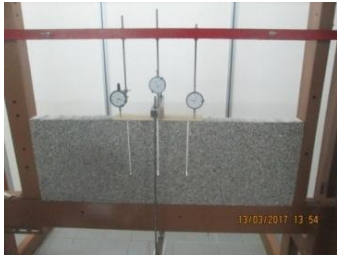
Gambar 8. Sistem pelat dengan 3 tiang.
