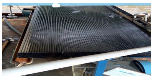
Gambar 2. Shaking table jenis slime table
