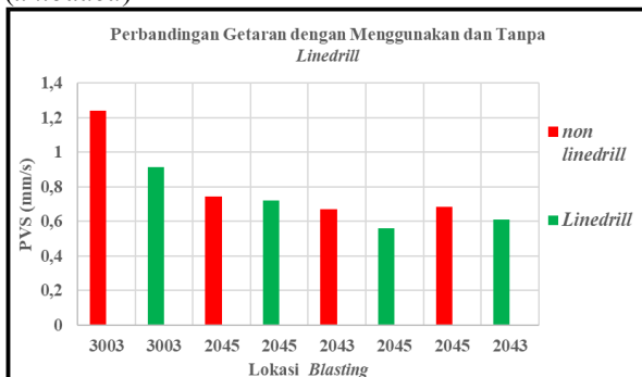
Gambar 8. Perbandingan Nilai Getaran Peledakan (PPV) antara Penggunaan dan Tanpa Penggunaan Linedrill
