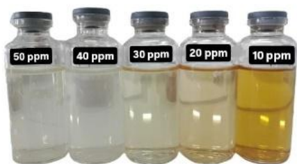
Gambar 9. Hasil Uji Deteksi Merkuri (II) dengan berbagai konsentrasi
