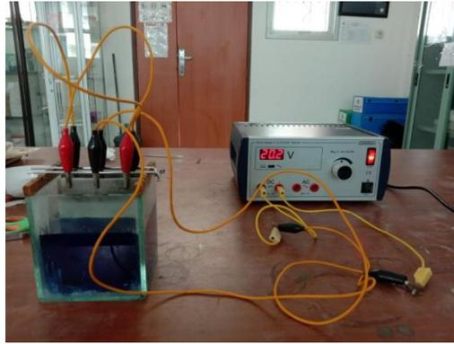
Gambar 1. Skema proses elektrokoagulasi
