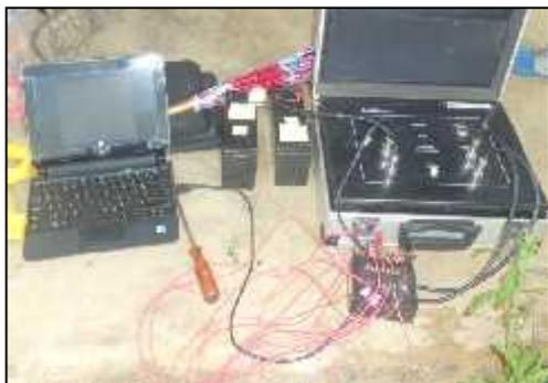
Gambar 3. Seperangkat alat metode geolistrik (*resistivity meter instruments*)
