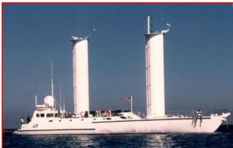
**Gambar 1 Dua buah silinder turbosail pada kapal**
