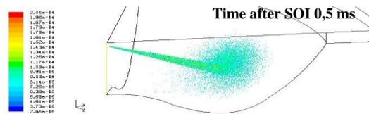
Gambar 4 Visualisasi droplet pada biodiesel Jatropa Curcas
