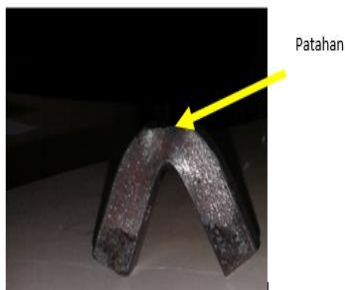
Gambar 6 Patahan Uji Impak
