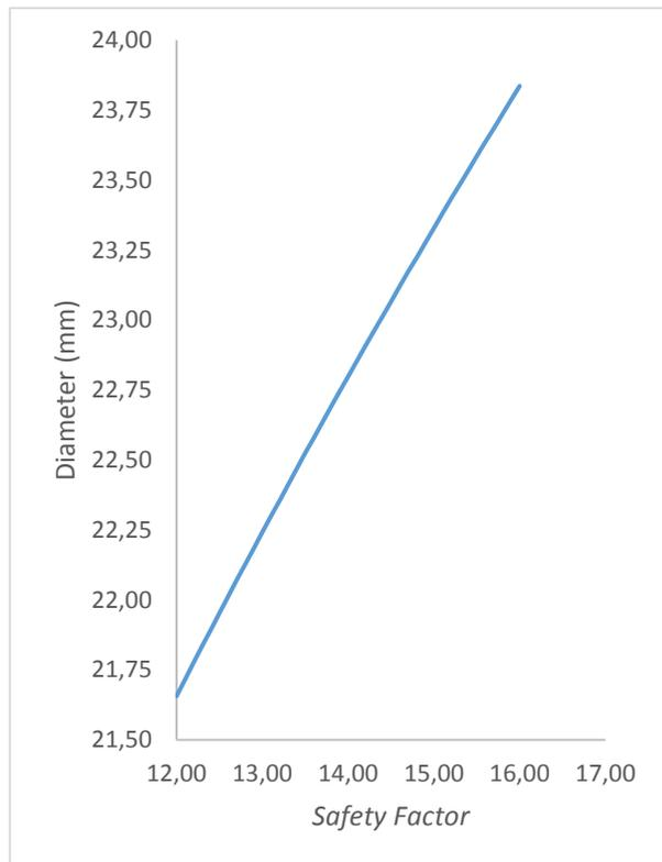
**Gambar 5** Perbandingan diameter poros dan *safety factor*
