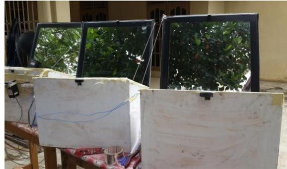
**Gambar 1 Rancangan Kompor Surya Tipe Kotak Yang Di Uji**
