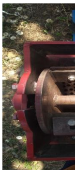
Gambar 4 Dudukan mata pisau dan pelindung mesin pencacah
