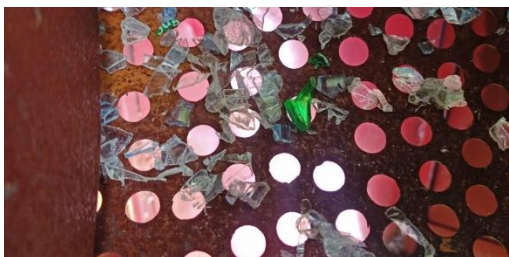
Gambar 3 Hasil cacahan yang tersangkut pada saringan
