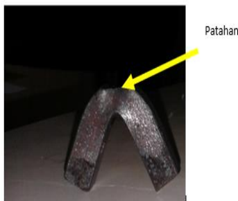
Gambar 6 Patahan Uji Impak
