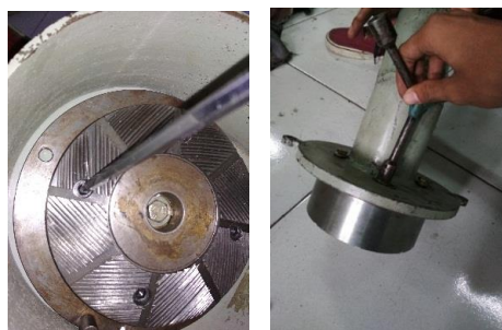
(a) pemasangan pisau gerak pada poros utama mesin penepung (b) pemasangan pisau diam pada casing mesin penepung
