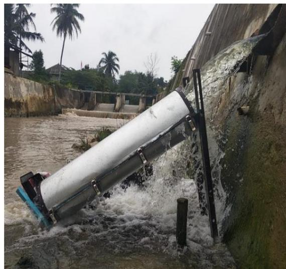
**Gambar 3 Pengujian turbin di lapangan**
