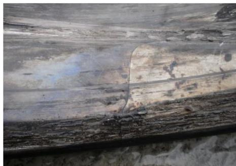
Gambar 10 Retakan pada Inner race bantalan
