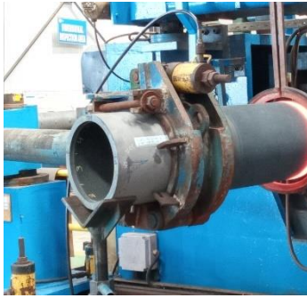
Gambar 3 Contoh Pipa yang Terpasang pada Clamp
