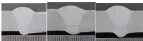
**Gambar 4 Hasil Uji Struktur Makro Pelat 2**
