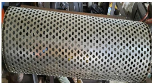
Gambar 3 Tabung pengupas tanpa poros pengaduk
