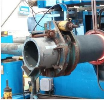
**Gambar 3** Contoh Pipa yang Terpasang pada Clamp
