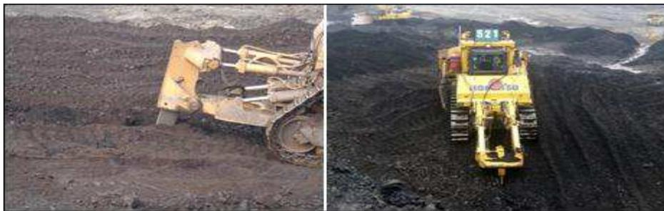
Gambar 5. Kegiatan pembongkaran batubara dengan menggunakan *Bulldozer*
