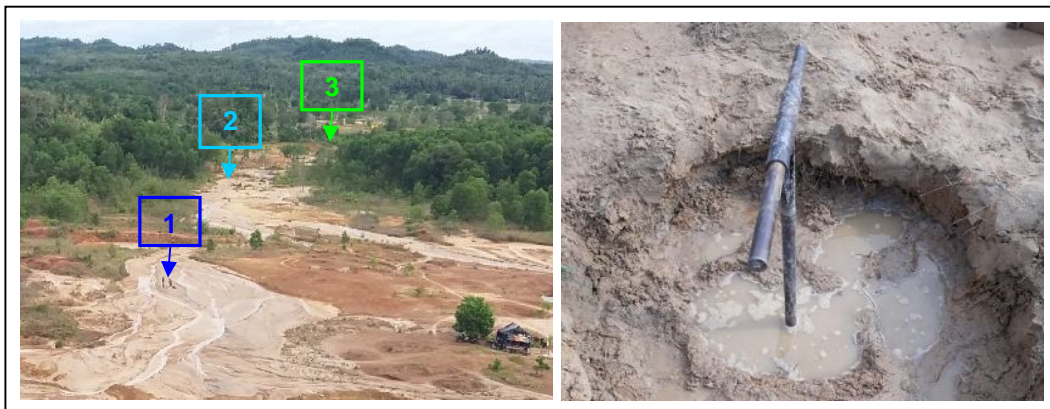
Gambar 2. Foto: (Kiri) Hamparan tailing dan posisi pemboran 1-3, (Kanan) Pemboran endapan tailing menggunakan Auger
