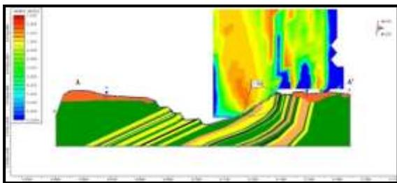
Gambar 7. Analisis Kestabilan Lereng aktual sayatan sisi *lowwall*
