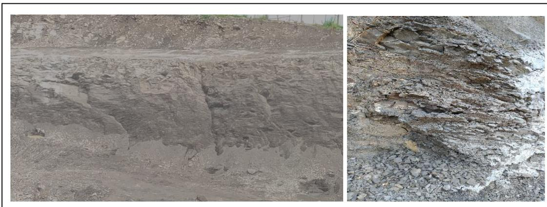
Gambar 2. Kondisi clay shale di Sentul City yang telah tersingkap
