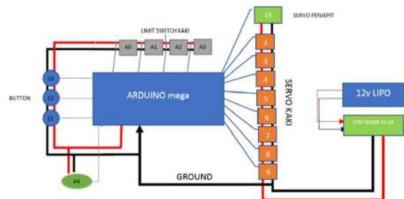
Gambar 1. Diagram Blok
