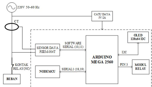
Gambar 1 Blok Diagram Sistem Kontrol & Monitoring Konsumsi Listrik
