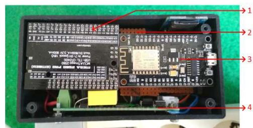
Gambar 2 Hasil Perakitan Alat Kontrol & Monitoring Konsumsi Listrik
